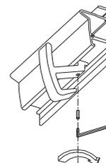
**3. FIJAR** el colgador *Fast-Fix* con un simple tornillo allen.
