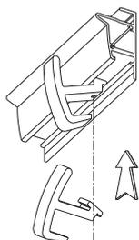
**1. INSERTAR** el colgador *Fast-Fix* en la ranura del perfil.
